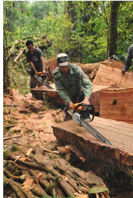
Zwei CFMG-Mitglieder sägen Bretter für die Renovation eines Hauses in ihrem Dorf (Bezirk Tsirang).
